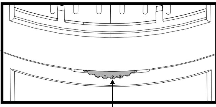
**Position d'allumage du registre d'arrivée d'air (entièrement ouvert) : à n'utiliser que pour des phases d'allumage et de reprise en gardant l'appareil sous surveillance!**
